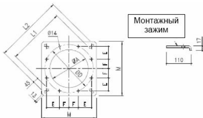
Квадратные фланцы для дисковых затворов, имеющие 4 монтажных зажима – серия FQ
